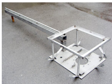
Rostfreie Konstruktion zum Einbetonieren.
